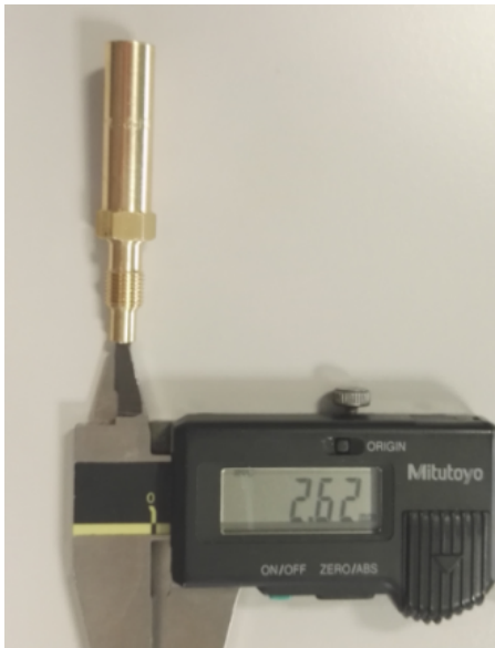
17.10.7) Le gicleur de ralenti Le gicleur de ralenti doit porter la mention "60". La pige de 0.65mm ne doit pas entrer dans le trou. (Utiliser le jeu de pignes Rotax réf. : 281 920).
