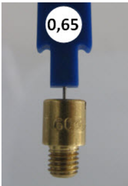
17.10.7) Le gicleur de ralenti Le gicleur de ralenti doit porter la mention "60". La pige de 0.65mm ne doit pas entrer dans le trou. (Utiliser le jeu de pignes Rotax réf. : 281 920).
