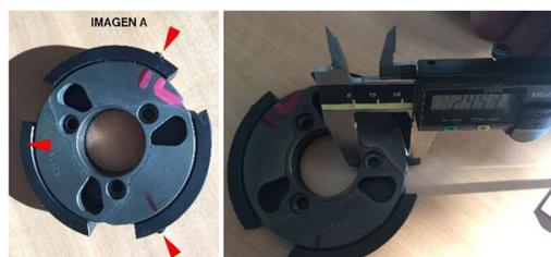
**6.7.7.3.** Diâmetro exterior da campânula. O diâmetro exterior da campânula deve ser medido conforme indica a imagem. A medição deve ser feita pelas costas da campânula e não pela parte da abertura da mesma (conforme imagem). O diâmetro mínimo é de 89,50 mm.
