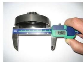
**6.7.7.5.** Altura da campânula com o pinhão montado. A altura mínima é de 33,90 mm
