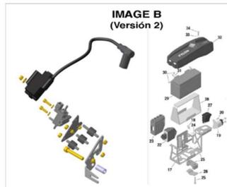
**7.12.2.** A caixa eletrônica é específica para a categoria Rotax Max DD2 e está marcada com um autocolante com o número da referência Rotax que é 666816. É permitido retirar o autocolante.
