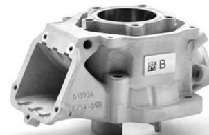
7.5.3. A altura do cilindro é de 86,70 mm -0,05/+0,1 mm.
