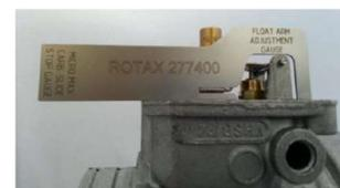
**6.9.4.** A agulha principal está marcada com o símbolo "INC" como na imagem e a sua válvula de assento está marcada com "150". Um calibre de diâmetro 1,56 mm não pode passar no orifício da válvula de assento.
