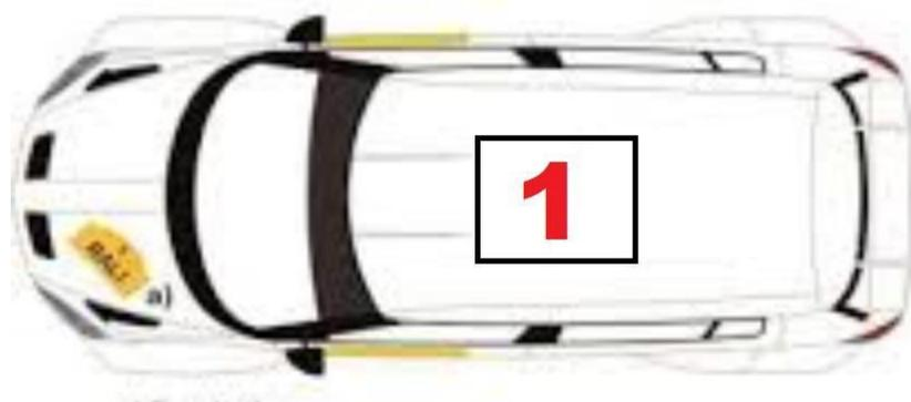
6.2 - Os Pilotos têm que obrigatoriamente deixar um espaço nas duas portas laterais da parte da frente e no tejadilho com as medidas acima referidas no Ex: 1
