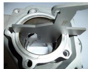
**6.4.13.2.** A peça deve ser inserida no cilindro, movendo a outra extremidade no ponto mais alto da janela de escape. Nesta posição, a peça pode não tocar na parede do cilindro.
