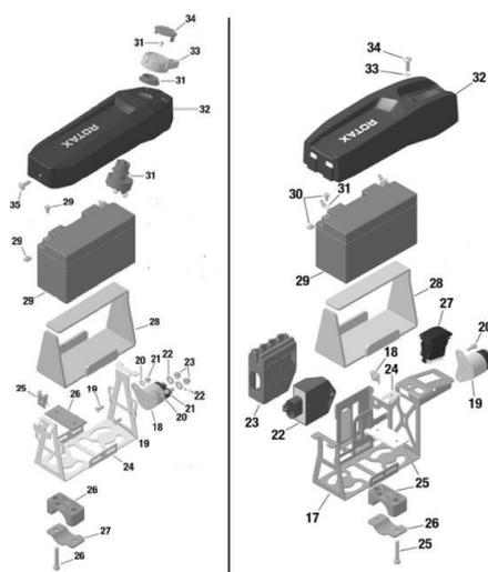
b) Na versão 2 a bateria deve estar fixada ao chassis através do suporte com a referência Rotax 251127 ou 251129 e apertada, no mínimo, por 4 parafusos, com a abraçadeira e tampa originais (referência Rotax 201602), com o botão de start e on/off (referência Rotax 264852). Também deve incluir o "relais", preso ao suporte (referência Rotax 992819) e o suporte do ECU.
