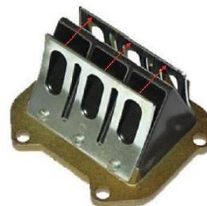
**6.6.4.** A espessura das lamelas é de 0,6 mm (+/- 0,10 mm).
