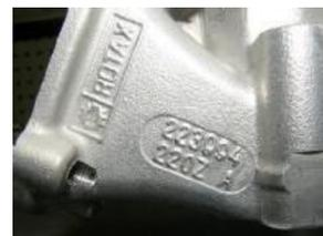
6.4.1.2. O cilindro do motor 125 Senior MAX Evo possui uma janela de escape principal e válvula de escape eletrónica é permitido o cilindro Single Core com referência Rotax 613372 e marcado com o número 223993, e logo "ROTAX". Cilindro com o código 413531 e marcado com o logo "ROTAX RACING".
