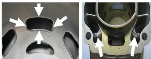
**6.4.8.** Nos cilindros 223 993, 223 994 e 613 933 é permitida a maquinação CNC (de fábrica) na parte superior do transfer central ("boost").
