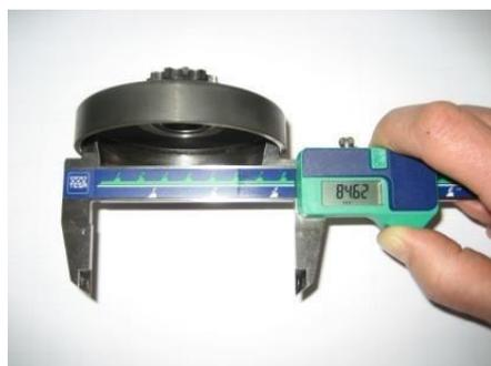
**6.8.7.5.** Altura da campânula com o pinhão montado. A altura mínima é de 33,90 mm.
