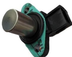
**6.7.4.4.** Nos cárteres com código 6211885, com a zona do pick-up maquinada conforme imagem, não é necessária a instalação de nenhuma junta adicional ao pick-up, além do anel de vedação original.
