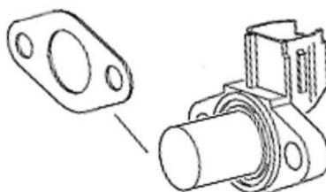
**a)** A espessura mínima da junta do pick-up com referência ROTAX 431500 é de 0,5 mm.
