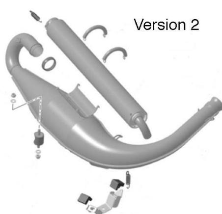
6.15.3.2. O silenciador pode rodar-se de forma a que o tubo de 90° de saída de gases de escape (referência Rotax 273210) permita a saída dos gases na direção do asfalto ou para trás.
