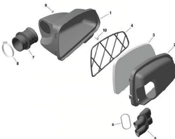
**7.21.4.** Há duas versões do filtro de ar (esponja). Uma está marcada no interior com a peça Rotax 225052 e tem suporte metálico incorporado na esponja. A outra tem referência Rotax 225054 e o suporte plástico da esponja em separado com a referência Rotax 225062.
