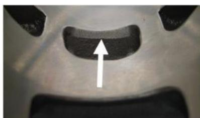
**6.4.9.** A parte superior da janela de escape pode apresentar superfícies apenas de fundição ou algumas zonas maquinadas de fábrica (CNC) ou sinais de maquinação (CNC) em combinação com sinais de acabamento manual. A janela de escape pode evidenciar algum acabamento manual feito pelo fabricante para eliminar defeitos menores de fundição e para eliminar restos de NIKASIL no final das zonas de banho de NIKASIL.
