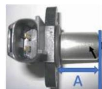
**6.7.4.2.** Não é permitido remover material ou apresentar sinais de desgaste na superfície de encosto do pick-up ao cárter.
