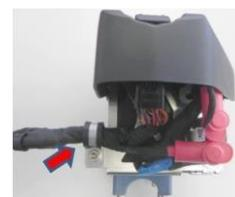
6.7.7.3. Nos motores 125 Micro MAX Evo, 125 Mini MAX Evo e 125 Junior MAX Evo, pode utilizar-se uma peça para tapar a ficha de ligação da válvula eletrónica, que tem como referência Rotax 666900.
