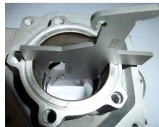
**6.3.7.2.** A peça deve ser inserida no cilindro, movendo a outra extremidade no ponto mais alto da janela de escape. Nesta posição, a peça pode não tocar na parede do cilindro.
