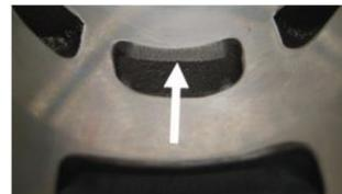
**6.3.4.4.** Nos cilindros 223 993, 223 994 e 613 933 é permitida a maquinação CNC (de fábrica) na parte superior do transfer central ("boost").
