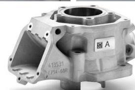
**6.3.2.** Diâmetro máximo do cilindro = 54,035 mm (medido 10 mm acima da janela de escape).
