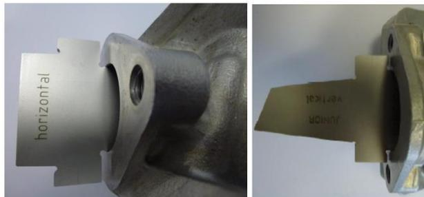
A peça deve mover-se na posição quer horizontal quer vertical, dentro da saída de escape. Em qualquer das direções a peça não pode tocar na parede da saída de escape, conforme imagem.
