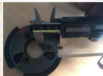
**6.7.7.3.** Diâmetro exterior da campânula. O diâmetro exterior da campânula deve ser medido conforme indica a imagem. A medição deve ser feita pelas costas da campânula e não pela parte da abertura da mesma (conforme imagem). O diâmetro mínimo é de 89,50 mm.
