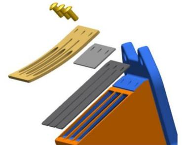
4.5.3. Os dois espaçadores têm a gravação "ROTAX", conforme o seguinte esquema. Cada espaçador tem de ser plano, sem curvatura, e cumprir com as especificações abaixo. A referência ROTAX pode estar gravada no espaçador.
