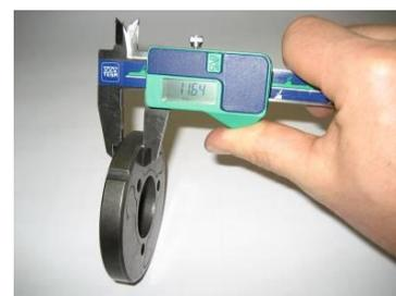
**6.7.7.2.** Altura da sapata da embraiagem (conforme imagem). A medida não pode ser inferior a 24,10 mm.
