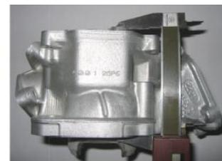
**6.3.3.** Altura do cilindro = 87,00 mm (-0,05/+0,1 mm).
