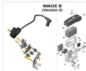
**7.12.2.** A caixa eletrónica é específica para a categoria Rotax Max DD2 e está marcada com um autocolante com o número da referência Rotax que é 666816. É permitido retirar o autocolante.
