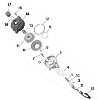
Nos Cilindros 223933 e 613933, é obrigatória a colocação de uma junta metálica (45) com referência Rotax 251336 e tem uma espessura mínima de 0,08 mm. É possível que esta junta metálica (45) mostre sinais de desgaste.
