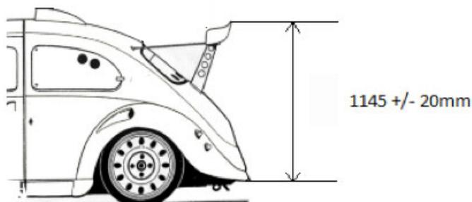
La dimension sera prise entre le rebord supérieur arrière de l'aileron et le bas du capot arrière. Cette cote sera de 1145 mm minimum avec une tolérance de plus ou moins 20 mm.
