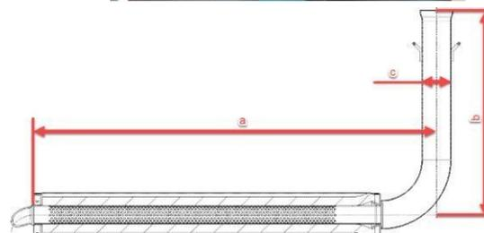
c) Uma esfera com 28,0 mm de diâmetro não pode passar pela Secção "A" (assinalada na imagem seguinte), enquanto que uma esfera com um diâmetro de 26,0 mm deve atravessar o escape por completo (escape sem componentes internos).
