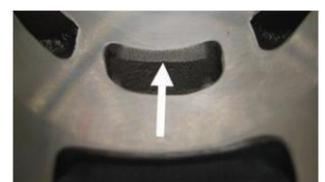
**6.7.8.** Nos cilindros 223 993, 223 994 e 613 933 é permitida a maquinação CNC (defábrica) na parte superior do transfer central (“boost”).
