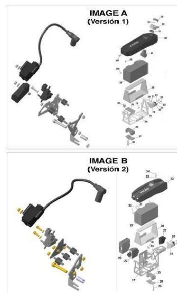
**7.16.2.** A caixa eletrônica é específica para a categoria DD2 MAX e está marcada com um autocolante com o número da referência Rotax que é 666816. É permitido retirar o autocolante.
