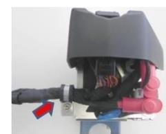
**6.10.7.4.** Nos motores 125 Micro MAX Evo, 125 Mini MAX Evo e 125 Junior MAX Evo, pode utilizar-se uma peça para tapar a ficha de ligação da válvula eletrônica, que tem como referência Rotax 666900.
