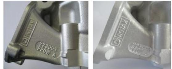
**6.7.2.** Diâmetro máximo do cilindro = 54,035 mm (medido 10 mm acima da janelade escape).
