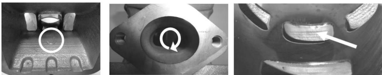
**6.7.11.** As dimensões horizontais e verticais da saída de escape (no cilindro Junior 223994, com asaída de escape totalmente mecanizada com CNC) deve-se verificar com a peça ROTAX referência 676240.
