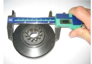
**6.7.7.4.** Diâmetro interior da campânula. A medição deve ser feita no meio (na área de contacto da campânula). O valor máximo do diâmetro interior é de 84,90 mm.
