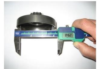
**6.7.7.5.** Altura da campânula com o pinhão montado. A altura mínima é de 33,90 mm
