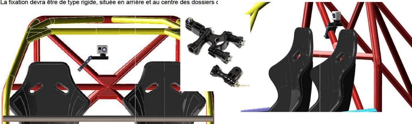
Pour les caméras de type « Crayon » elles pourront être fixées sur le montant de l'arceau avant et le boîtier devra être fixé sur le plancher (idem fixation batterie) derrière les sièges.
