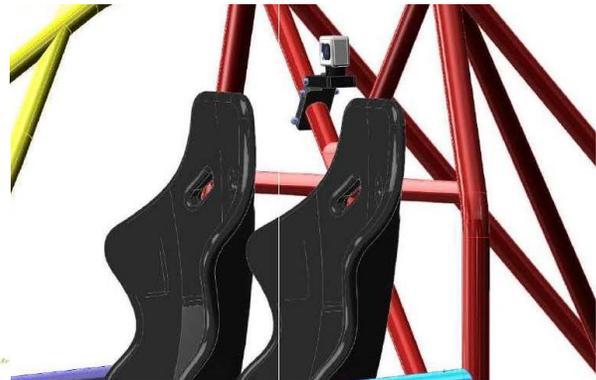
Pour les caméras de type « Crayon » elles pourront être fixées sur le montant de l'arceau avant et le boîtier devra être fixé sur le plancher (idem fixation batterie) derrière les sièges.
