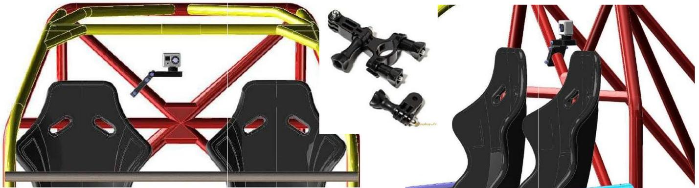
Pour les caméras de type « Crayon » elles pourront être fixées sur le montant de l'arceau avant et le boîtier devra être fixé sur le plancher (idem fixation batterie) derrière les sièges.
