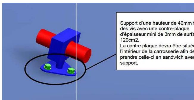
Support d'une hauteur de 40mm fixé par des vis avec une contre-plaque d'épaisseur mini de 3mm de surface de 120cm<sup>2</sup>. La contre plaque devra être située à l'intérieur de la carrosserie afin de prendre celle-ci en sandwich avec le support.
