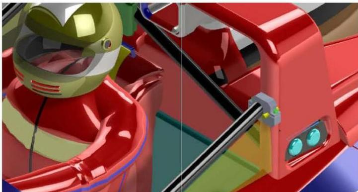
Support de la caméra crayon fixé mécaniquement sur le tube d'arceau
