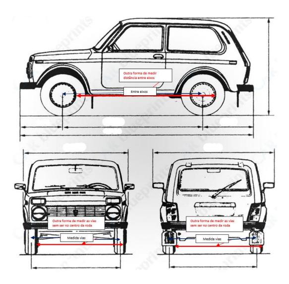
A largura das vias é medida no centro do pneu de um lado para o centro do pneu do outro lado, assim e como é uma medida de centro a centro, é mais fácil medir do interior de um pneu para o exterior do outro pneu. (Seta a vermelho)
