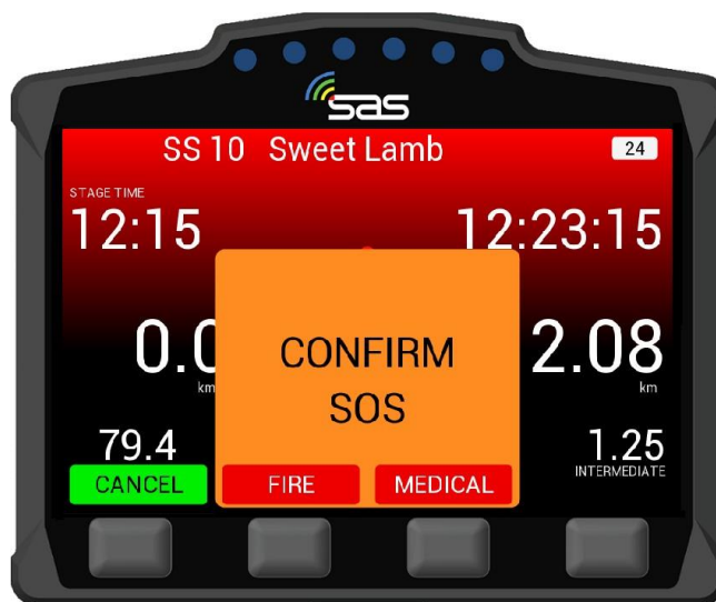
ECRÃ 8. Confirme SOS de incêndio ou SOS médico
