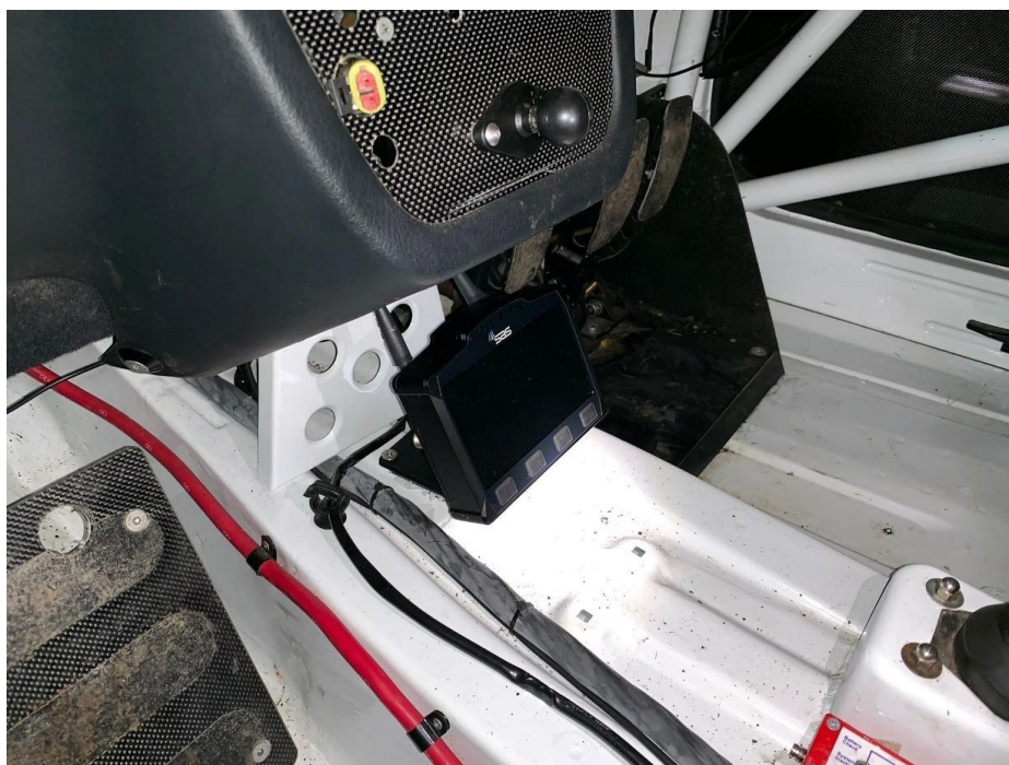
Figura 2. A unidade de rastreio SAS montada no suporte da bola de borracha de 25 mm e conectada através do conector RallySafe
